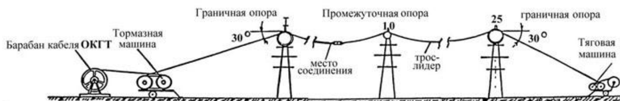
Рисунок 14.2 - Протягивание провода СИП на опоры
