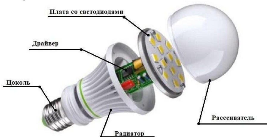
Рисунок 1.5 – Устройство светодиодной лампы
