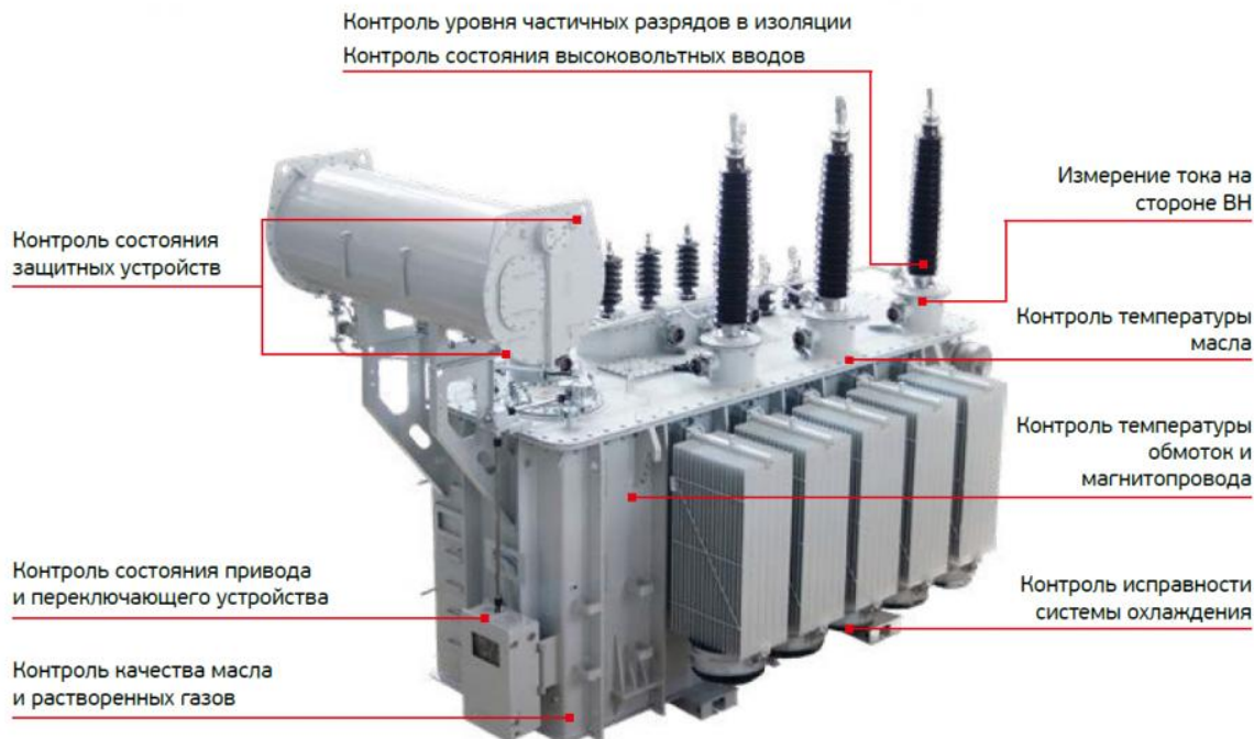
Рисунок 18 – Дополнительные функции управления, мониторинга и диагностики трансформаторов
