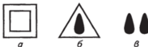
Рисунок 93 – Маркировочные знаки ручного электроинструмента: а — с двойной изоляцией класса II; б — брызгозащищенного исполнения; в — водонепроницаемого исполнения
